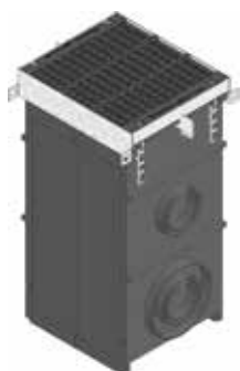
Sumidero completo con reja de fundición dúctil SW 3x140/20 mm, Clase E 600
